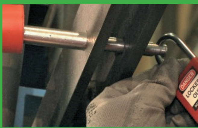
Mechanikus leválasztás: védelem egy tolóajtónál (mechanikus + lakat).
