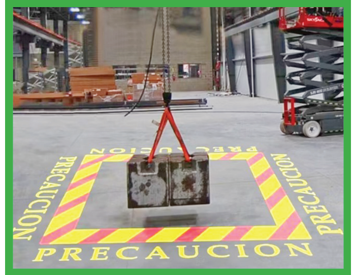
A futódarukat figyelmeztető lámpákkal kell felszerelni, amelyek a lenti munkaterületre világítanak.
