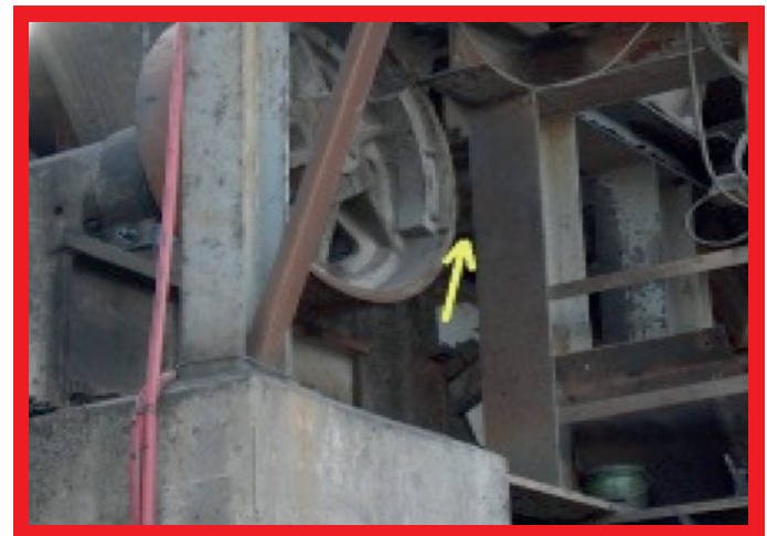
Halálos baleset a vállalatcsoportnál - Esettanulmány, 2006: Adott emelési művelet során a felügyelő személy beszorult az emelt teher és egy acélgerenda közé.
