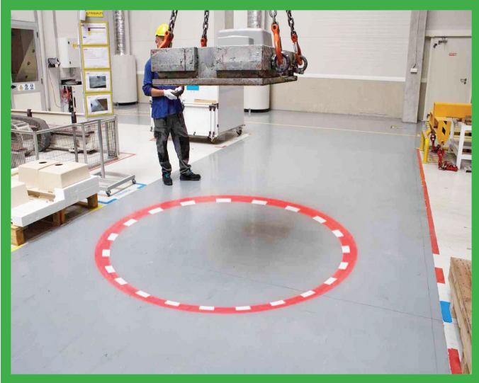
A futódarukat figyelmeztető lámpákkal kell felszerelni, amelyek a lenti munkaterületre világítanak.
