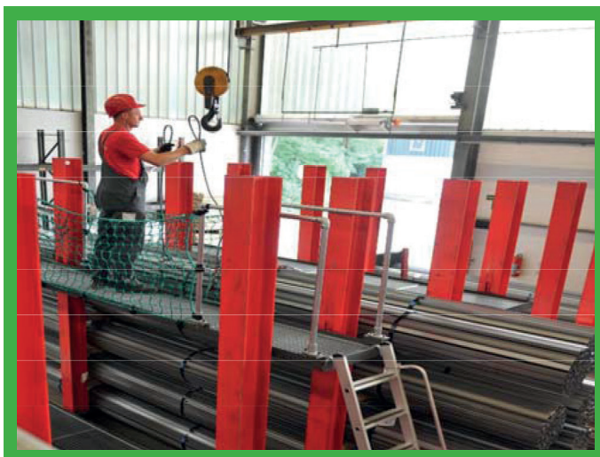
Bezpečný prístup pre pripojenie zdvíhacích hákov.
