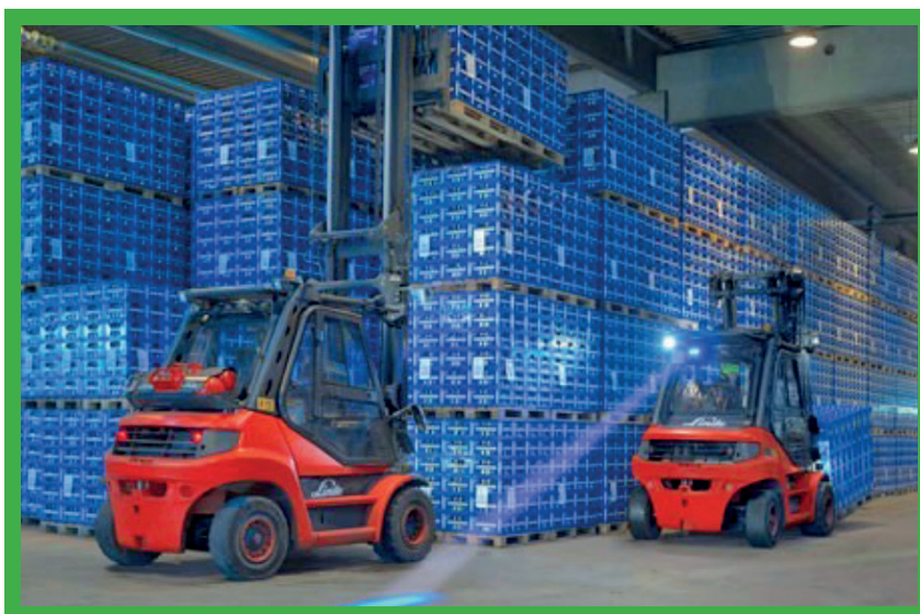
System modrého bodového svetla „Blue Light“ v činnosti.
