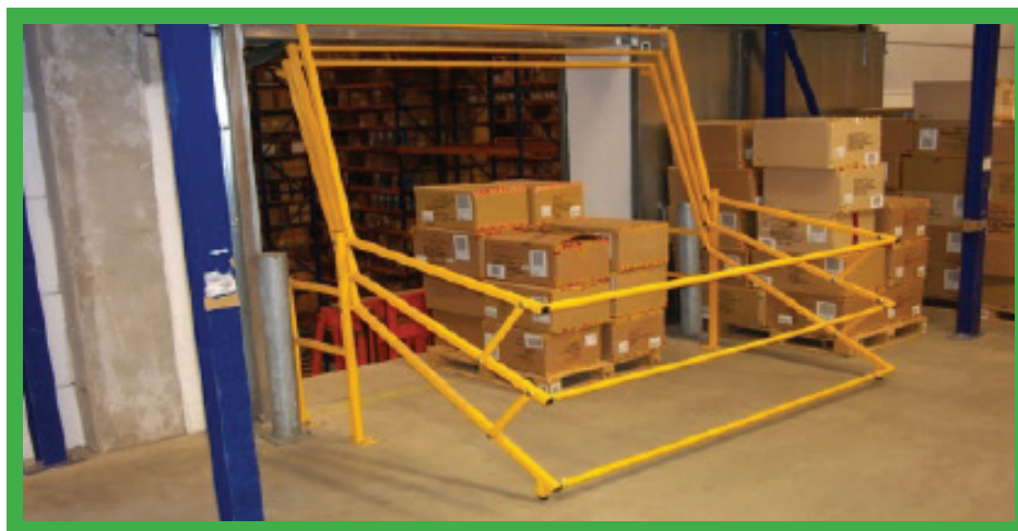
Systém otočnej klietky, ktorý poskytuje ochranu proti pádom.
