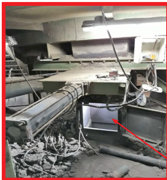
31. október 2017: Dodávateľ, vykonávajúci čistiace práce, vstúpil na potrubie, keď sa chybne otvorila pneumatiká klapa medzi potrubím a násypníkom – dodávateľ bol zavalený a utrpel smrteľné zranenia.
