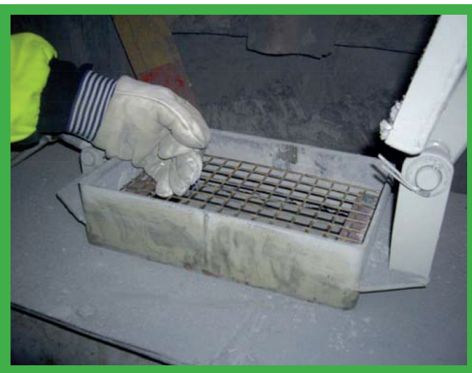
Inšpekčný poklop (so zaistenou mriežkou) na závitnicovom dopravníku.
