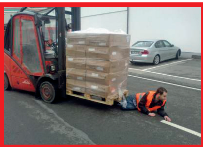
Rekonštrukcia vážnej nehody – marec 2015: Pracovníka zrazil vysokozdvížný vozík, ktorý išiel smerom dopredu. Výhľad vodiča obmedzoval náklad.
