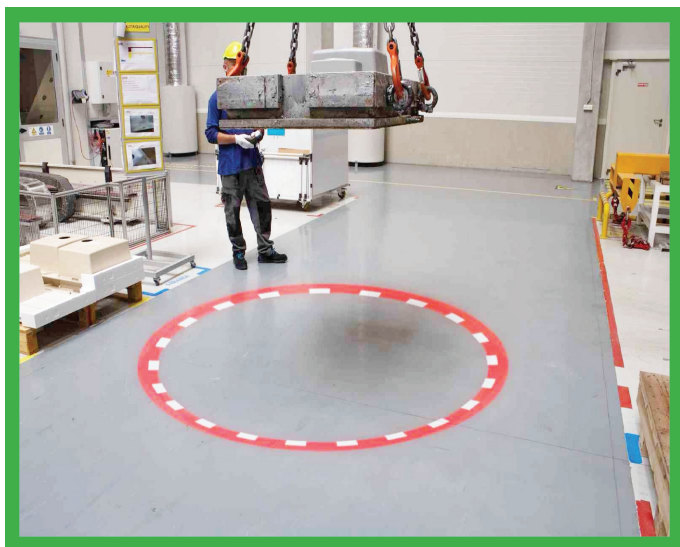
Mostové žeriavy vybavené výstražnými svetlami, ktoré svietia na pracovnú oblasť pod nimi.
