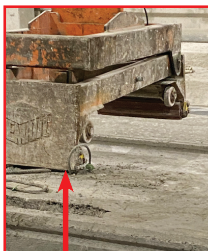
Keď sa však svorky posunuli nahor, spojili sa so zdvíhacím okom. Tento ťah na úchytsposobil, že sa doska posunula a skĺzla z hromady dosiek (pozri ďalšiu fotografiu) – operátor predpokladal, že svorky sú úplne uvoľnené.
