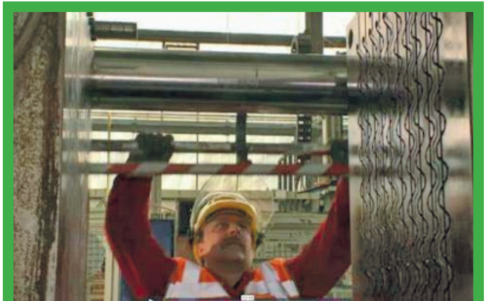
Mechanická izolácia: zaistenie posuvných dverí (Mechanická + visací zámok).
