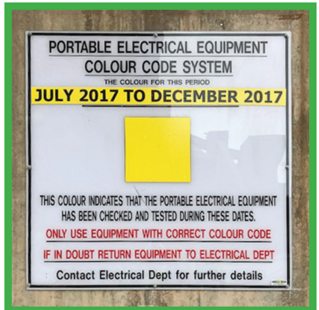
Inštrukcie pre všetkých používateľov prenosného elektrického zariadenia – používajte iba zariadenie so správnym farebným kódom štítku pre dané obdobie.
